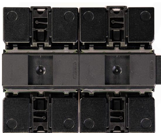
Fig. : Solar-Log Base et MOD I/O assemblés avec connecteur de bus.
