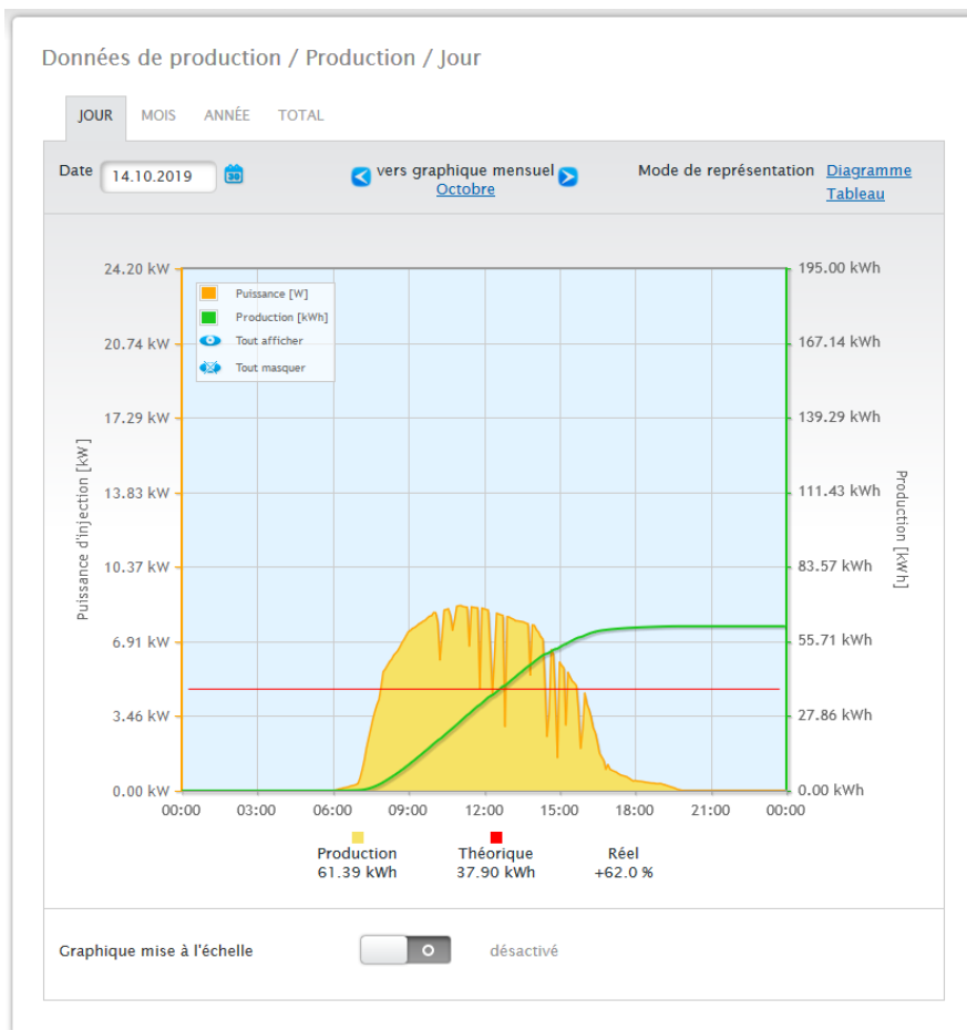
Fig. : Graphique Vue Production Jour avec mise à l'échelle automatique désactivée
