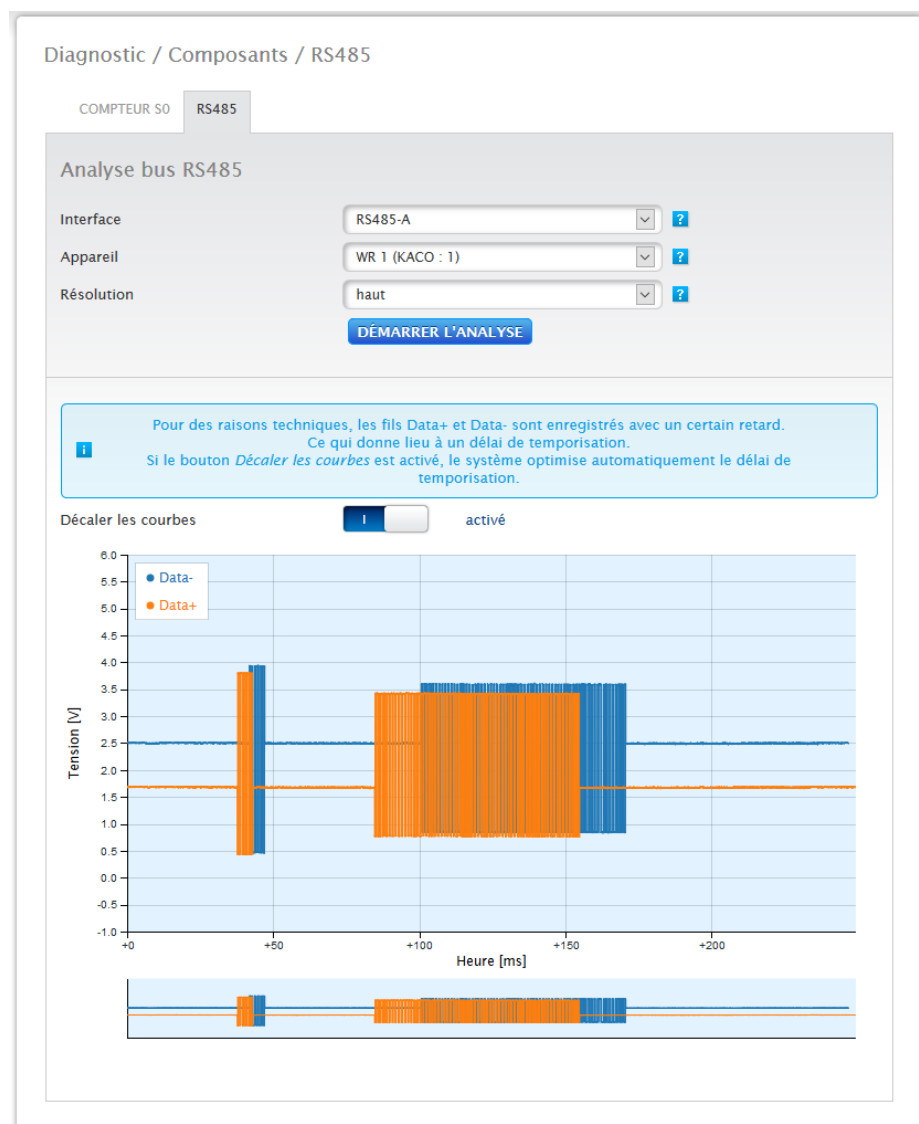
Fig. : Analyse bus RS485, exemple Janitza (mode d'installation activé)
